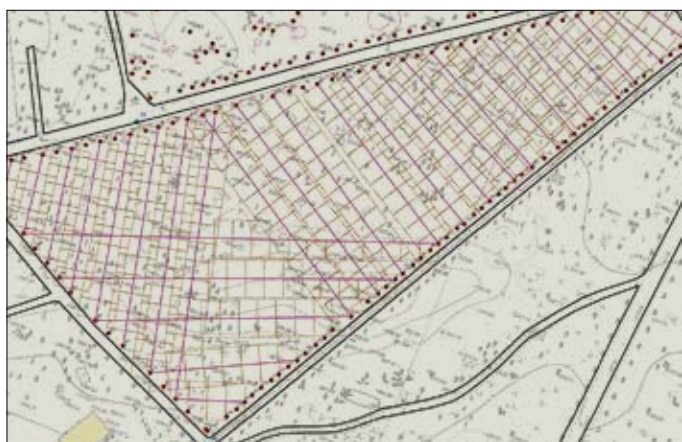
Рис. 2. Использование осевых линий с 5-метровым квадратованием на модельном полигоне №2
